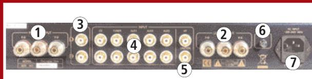
*Vue arrière du panneau de liaisons. 1/2 – Borniers vissant plaqués or (WBT) de sorties HP avec choix des impédances 4/8 Ohms. 3 – Sortie modulation pour magnétophone. 4 – Cinq entrées modulation haut niveau 240 mV/100 kOhms. 5 – Entrée Home Theater « Pass Thru » pour liaison avec processeur home cinéma extérieur, supprime complètement la section préampli sur le trajet du signal (afin d'avoir le moins de bruit de fond possible). 6 – Borne vissante de mise à la masse. 7 – Prise secteur.*
